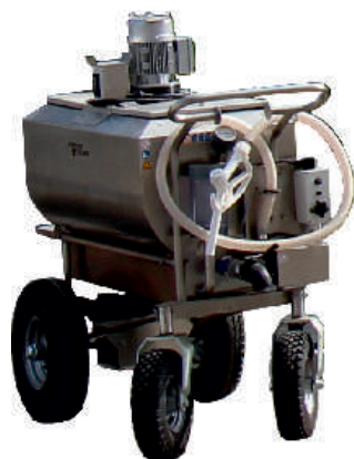
mobilní vozík na mléčnou krmnou směs, objem 180 l, ohřev, dávkovací pistole
