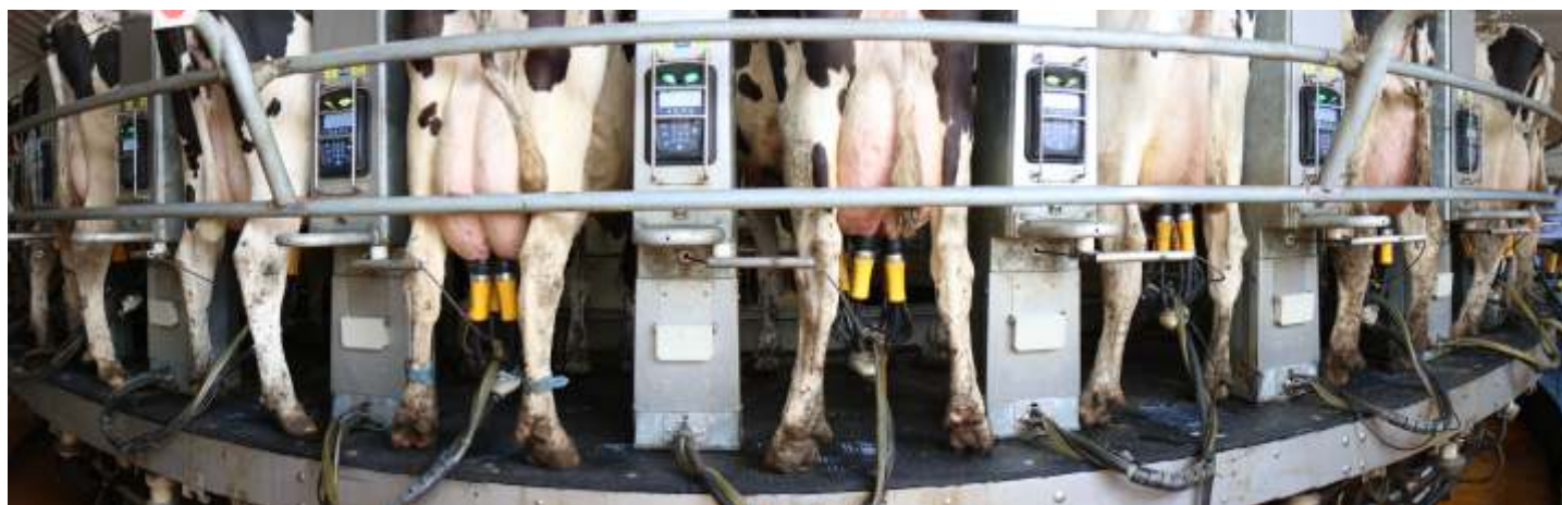
Kruhová dojírna FARMTEC vybavená technologií automatického postdipu ADF Invent.
