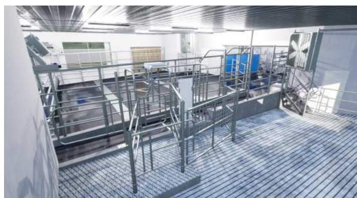
Vizualizace kruhových dojíren FARMTEC, přiháněče se shrnováním v čekárně dojnic a selekční branky na výstupu z dojírny.
