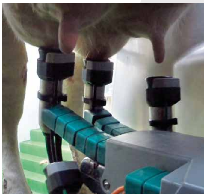
Kamera TOF nasazuje stále se stejnou precizností
