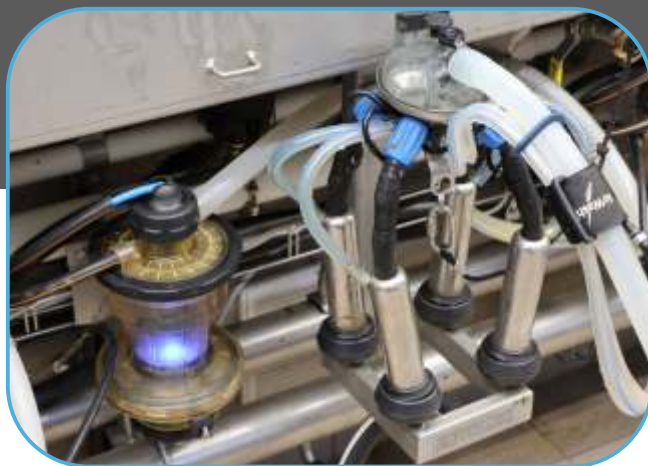
dojící stroj se systémem AirWash Plus a měřič nádoje iMilk 600
