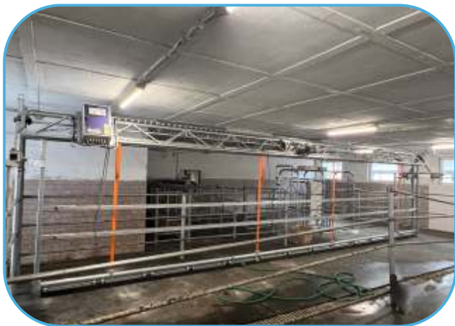
čekárna dojnic s příháněčem se shrnováním kejdý
