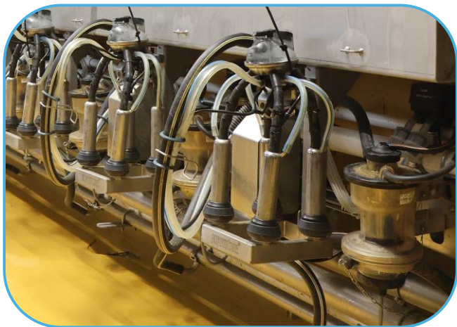
dojící stroj s měřičem nádoby iMilk 600
