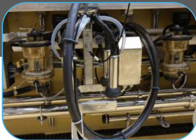
dojící stroj s měřičem nádoje iMilk 600
