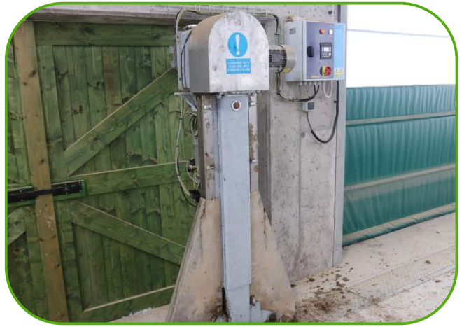
pohonná jednotka s automatickým doplněním řetězu
