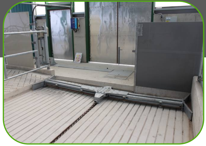
skládací shrnovací řetězová lopata
