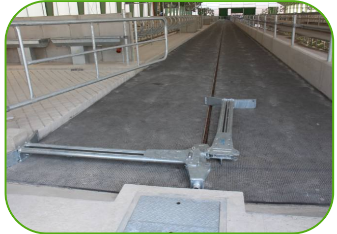
snížené skládací shrnovací řetězové lopaty
