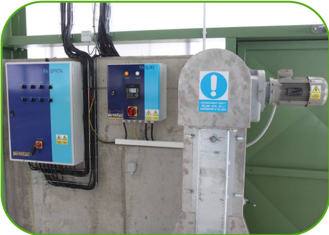
pohonná jednotka pro vyhrnování kejdy - systém Delta II
