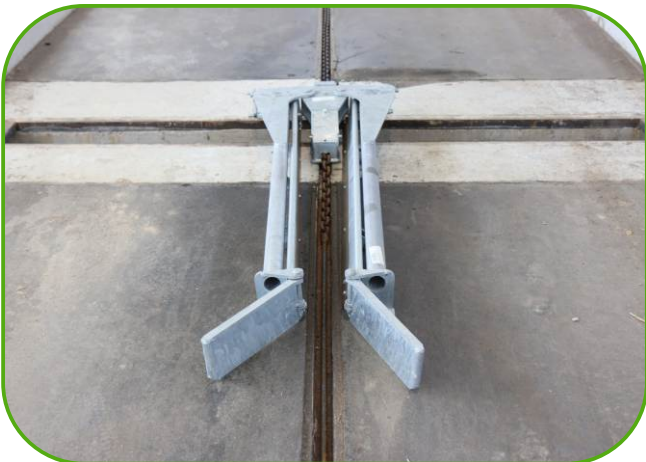
řetězová shrnovací lopata na odklíz kejdy, systém DELTA II
