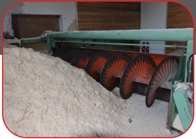
podávací šnek vstupního dopravníku
