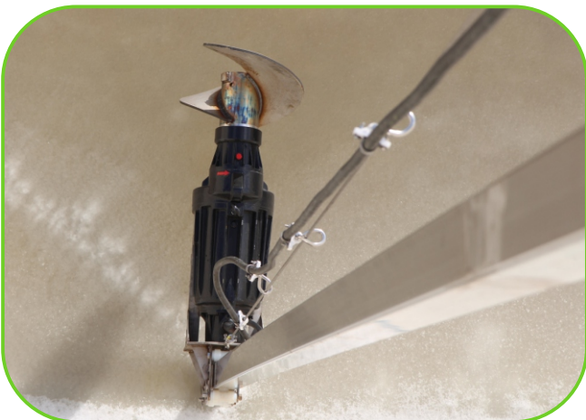
míchadlo kejdy s nerezovou vrtulí
