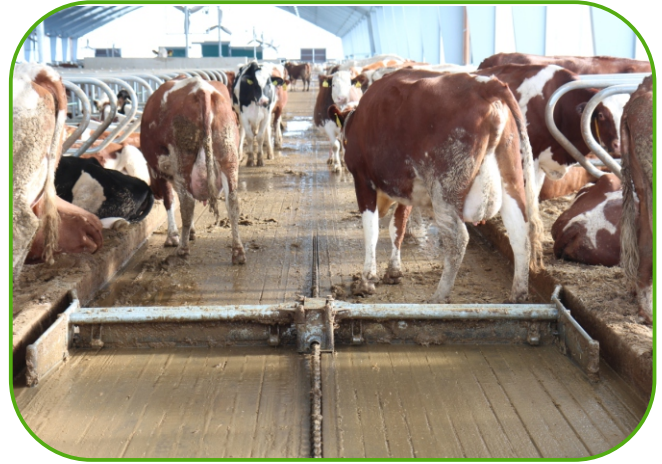
řetězová skládací shrnovací lopata - systém DELTA
