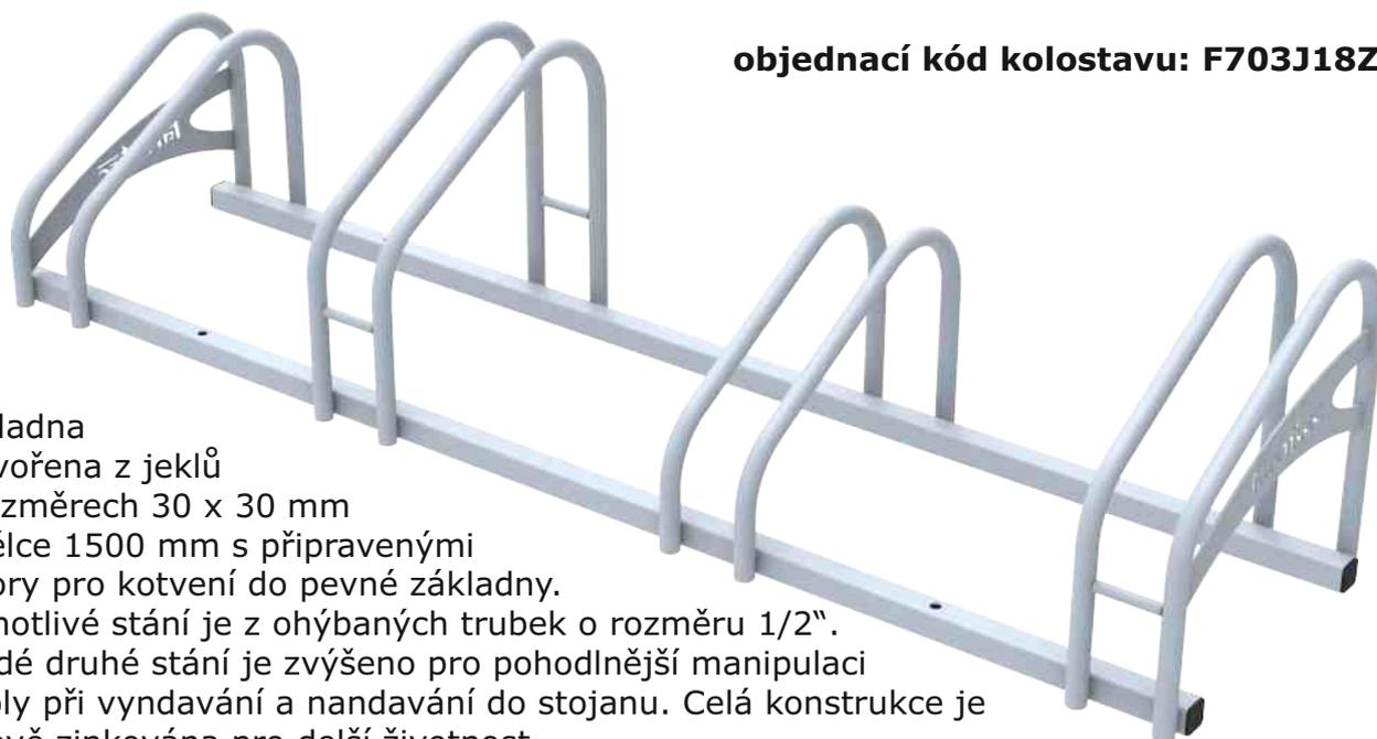
Základna je tvořena z jeklů o rozměrech 30 x 30 mm v délce 1500 mm s připravenými otvory pro kotvení do pevné základny. Jednotlivé stání je z ohýbaných trubek o rozměru 1/2". Každé druhé stání je zvýšeno pro pohodlnější manipulaci s koly při vyndávání a nandávání do stojanu. Celá konstrukce je zároveň zinkována pro delší životnost.
