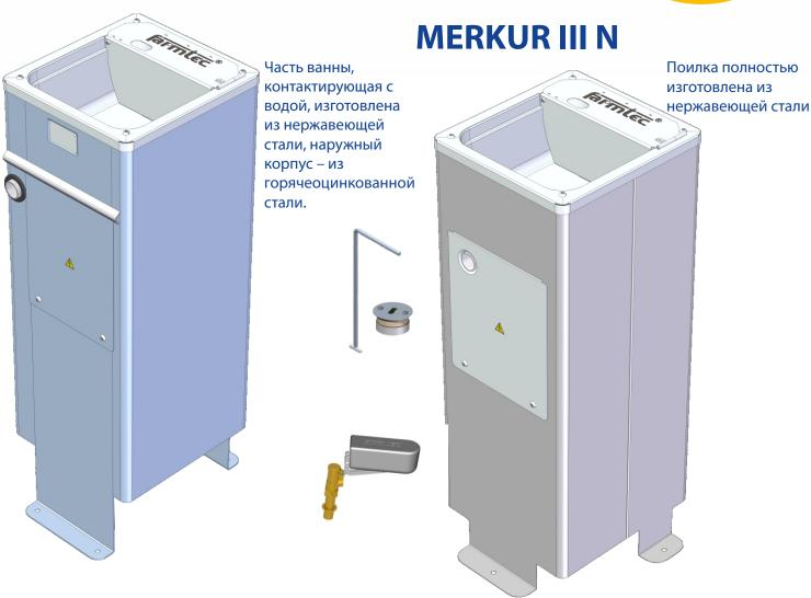
объем 13 л, рекомендуется из расчета на 15 гол. (1 гол. = 500 кг), Напряжение питания 230 V, мощность поилки 60 W (при 5°C), пропускная способность впускного клапана (при 0,3 MPa) 13 л/мин, впускной клапан G 1/2" расположен в стойке поилки, электропитание подается в распределительную коробку в стойке поилки, дно поилки оснащено выпускной пробкой диаметром 42 мм, степень защиты IP 55.
